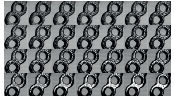
Makrosequenz eines Polierprozesses mit DryLyte Technologie.
