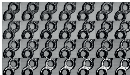
Macrosequenza di un processo di lucidatura con DryLyte Technology.
